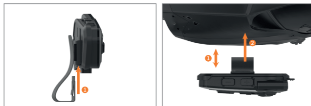
2. 메탈클립의 짧은쪽을 도크 스테이션 하단부에 밀어서 장착합니다. 3. 메탈클립의 긴쪽을 헬멧 쉘 좌측 하단부에 밀어서 장착합니다.
